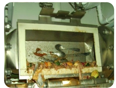
Öffnen Sie den Rohrmagnet und entnehmen Sie die Metallteile. Vor dem Schließen der Klappe muss die Dichtung auf Sauberkeit geprüft bzw. gereinigt werden.
