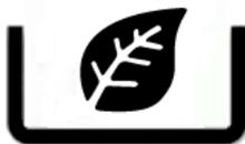
In den Stillstandzeiten (Pausenzeiten) zeigt die Maschine durch das Blatt-Symbol an, dass Energie gespart und die Bauteile geschont werden.
