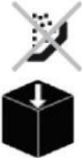
Die Haube soll geschlossen werden, ohne dass ein Programm gestartet wird. Nach Durchführen des letzten Spülganges wird das Symbol **Spülstart unterbinden** angezeigt.
