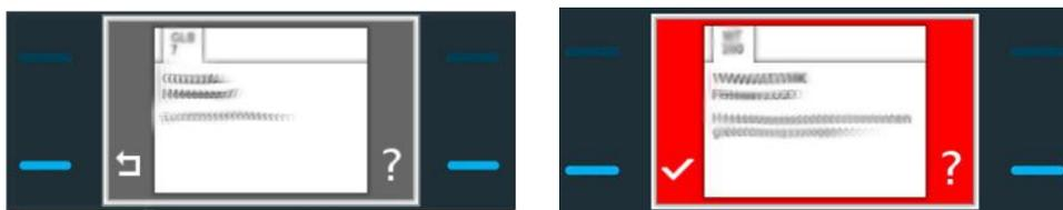
Bei Auftreten einer Störung werden im Display je nach Störungsart, graue oder rote Meldungen angezeigt.
