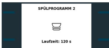
Nach einem Wechsel des Spülprogramms wird nach ca. 3 Sekunden die Laufzeit kurz angezeigt. Dadurch kann die richtige Wahl des erforderlichen Spülprogramms überprüft werden.
