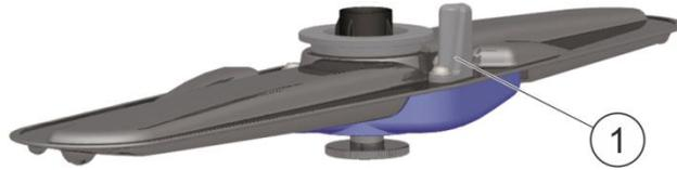
6. Damit der Sensor die Drehung des Spülarms erkennt, alle Schmutzpartikel und eisenhaltige Partikel, die am Magneten (1) haften, entfernen.
