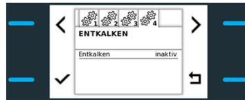
Im i-Menü können unter dem Reiter **Dosiertechnik** die Entkalkungszeit und -temperatur angepasst werden.
