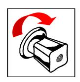
Öffnen Sie das Absperrventil der Wasserzuleitung.
