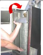
Setzen Sie das Siebrohr und die Schnecken-spindel ein.
