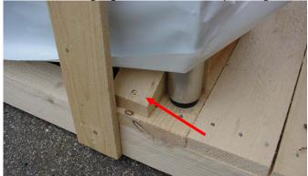
z.B.: diese und weitere Schrauben entfernen!
