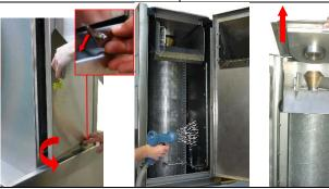
Öffnen Sie die Tankabdeckung und die Reinigungstür der Nassmüllpresse. Spülen Sie den Turminnenraum aus. Öffnen Sie den Turmdeckel.
