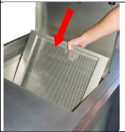
Setzen Sie das Sieb in den Tank ein.
