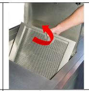
Entfernen Sie nun Restabfälle, Metallteile usw. mit den Bodensiebkasten aus dem Tank. Leeren und reinigen Sie den Bodensiebkasten.
