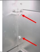
Reinigen Sie die Elektroden für Niveauregelung.
