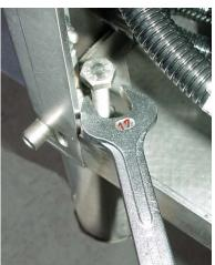
Beim endgültigen Aufstellen der Maschine darauf achten, dass alle Maschinenstollen ungefähr das gleiche Gewicht tragen.
