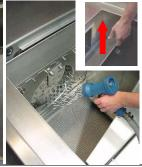
Heben Sie die Klappe an und spülen Sie mit dem Wasserschlauch, möglichst mit Warmwasser, Tank und Zerkleinerungswerk aus.
