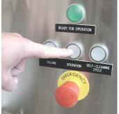
Drücken Sie den Drucktaster "Betrieb". (Bedienfeld AZP 80)
