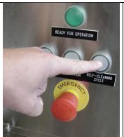
Drücken Sie den Leuchtdrucktaster "Reinigungsnachlauf". Nach ca. 15 Minuten endet dieser Nachlauf automatisch. (Bedienfeld AZP 80)
